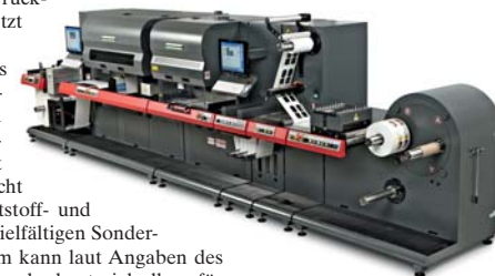
Die Jetrion 4900 arbeitet mit UV-Tinten für den Druck von CMYK und Weiß.
